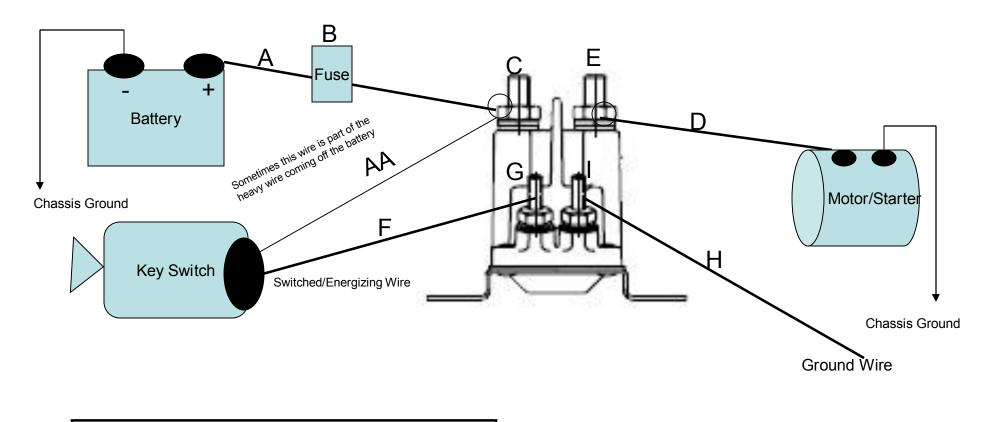
Note: Do not remove nut from stud (C) or stud (E). Do not remove nut from stud (G) or stud (I)
